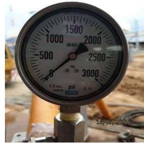
(8) การทดสอบท่อด้วยวิธีทางชลสถิต (Hydrostatic Test)
